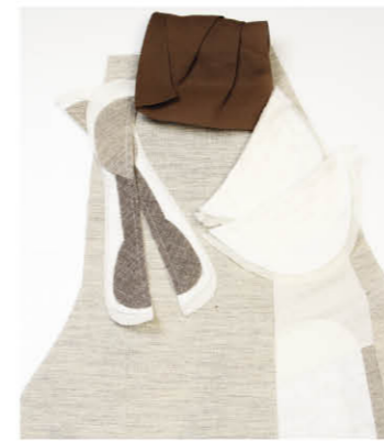
芯地には高級スーツの代名詞とも言える本バスを使用。立体感のあるシルエットをつくり出し、耐久性にも優れていてフィット感のある着心地が長続きする
